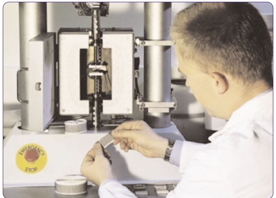
Ingeniero probando la fortaleza de un cierre térmico de Velcro
