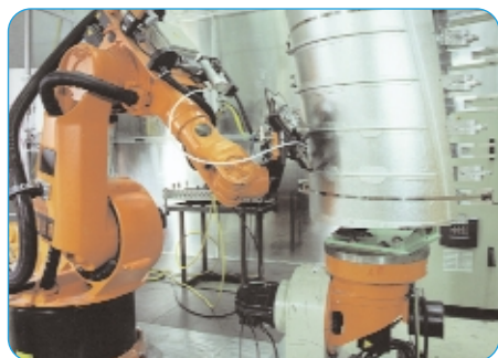
Proteger el medio ambiente. El desarrollo del proceso de soldadura láser para los materiales de aluminio para sustituir la tecnología tradicional de mecanizado y remachado, que debilita los materiales y produce residuos metálicos
