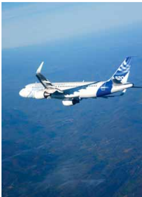
A320 équipé de nouvelles extrémités de voilure « sharklets »
