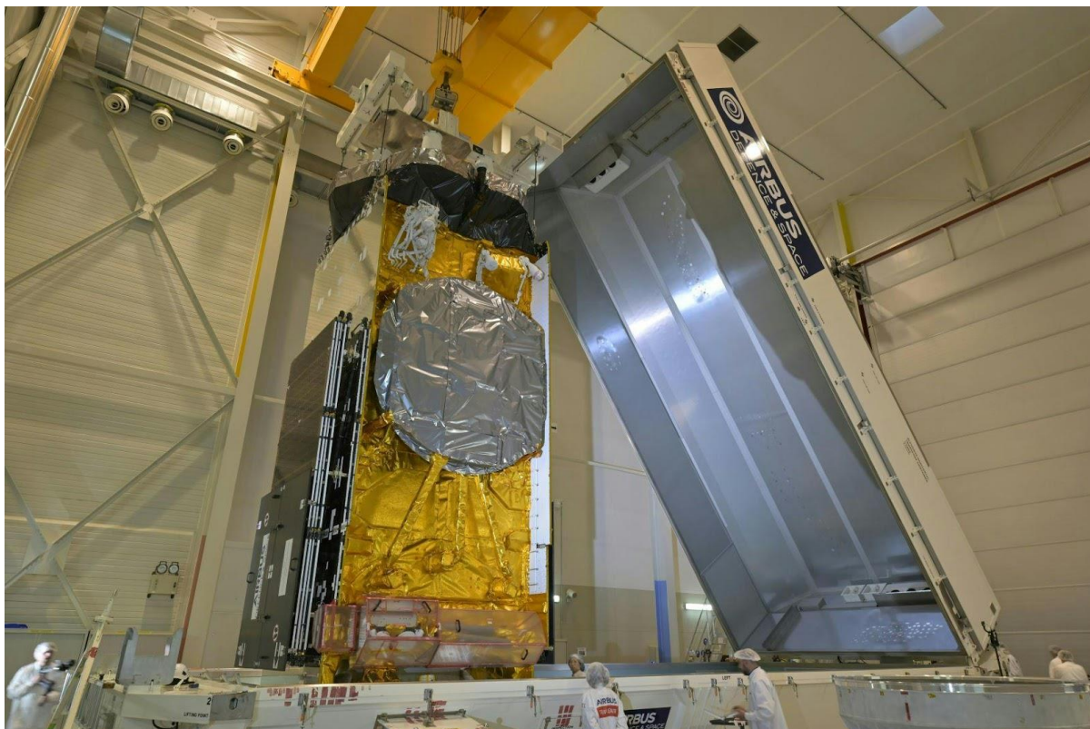
Embalaje del satélite EUTELSAT 36D en su contenedor de transporte - Copyright Airbus
