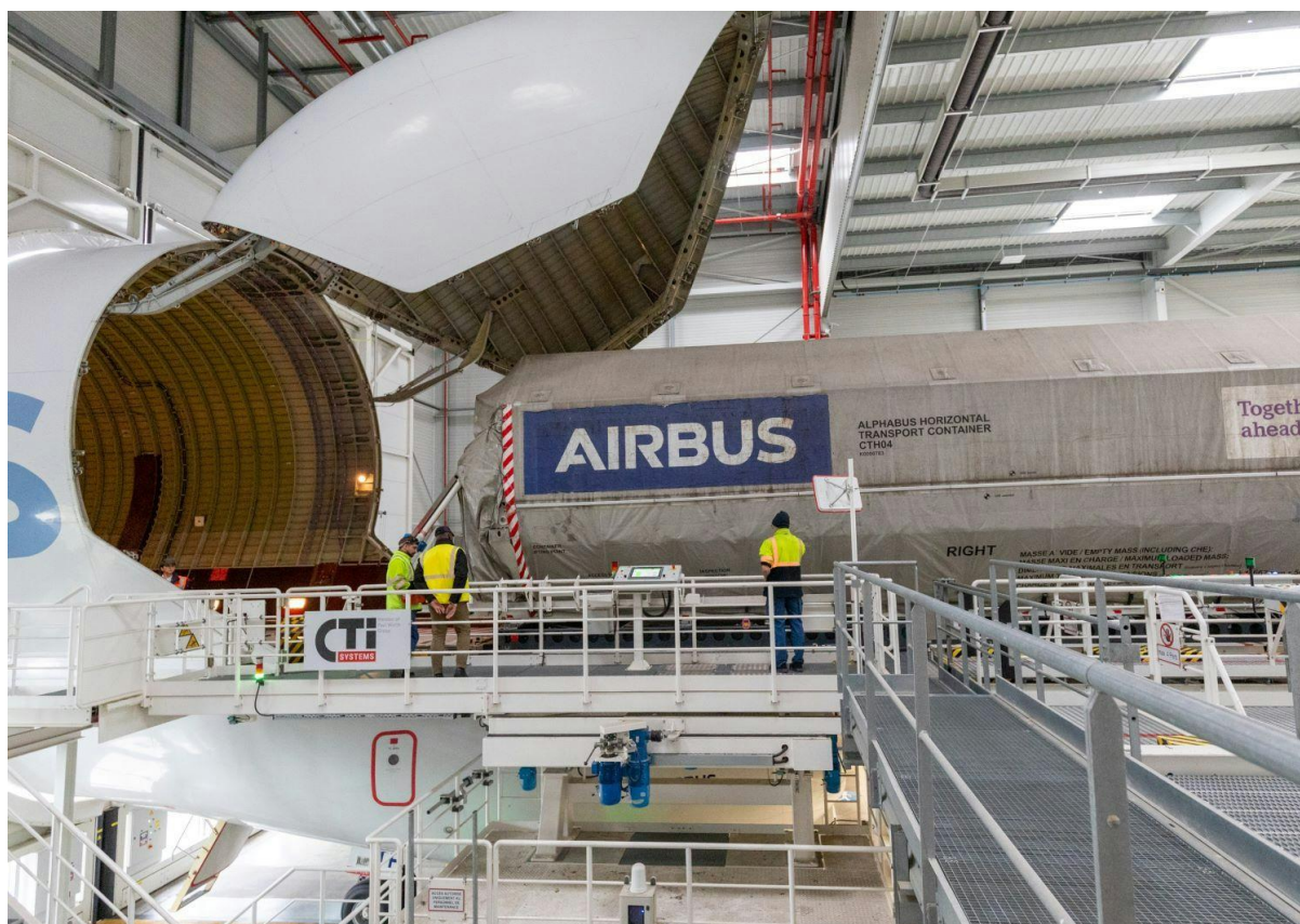
Carga del contenedor del satélite en el Beluga – Copyright Airbus
