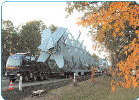
Essais de transport des principaux tronçons de l'A380
