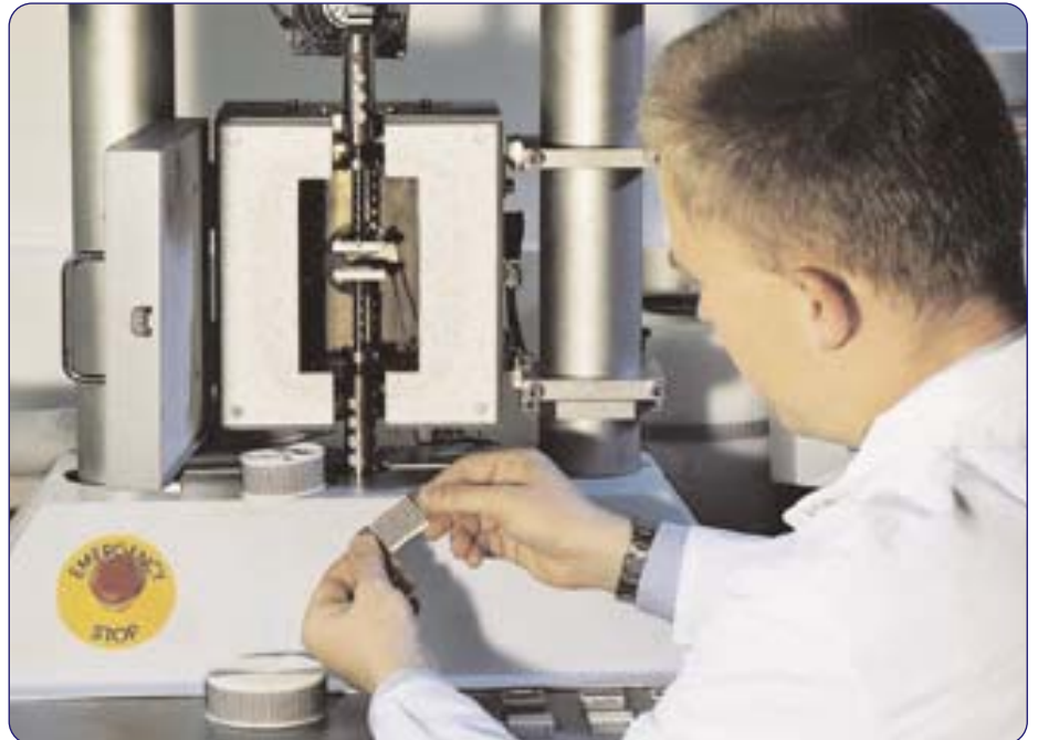
Ingénieur testant la résistance d'une fixation thermique par Velcro
