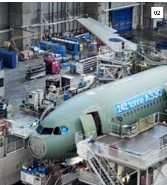
01 – A380 02 – Montage der A330 mit 242 Tonnen Startmasse
